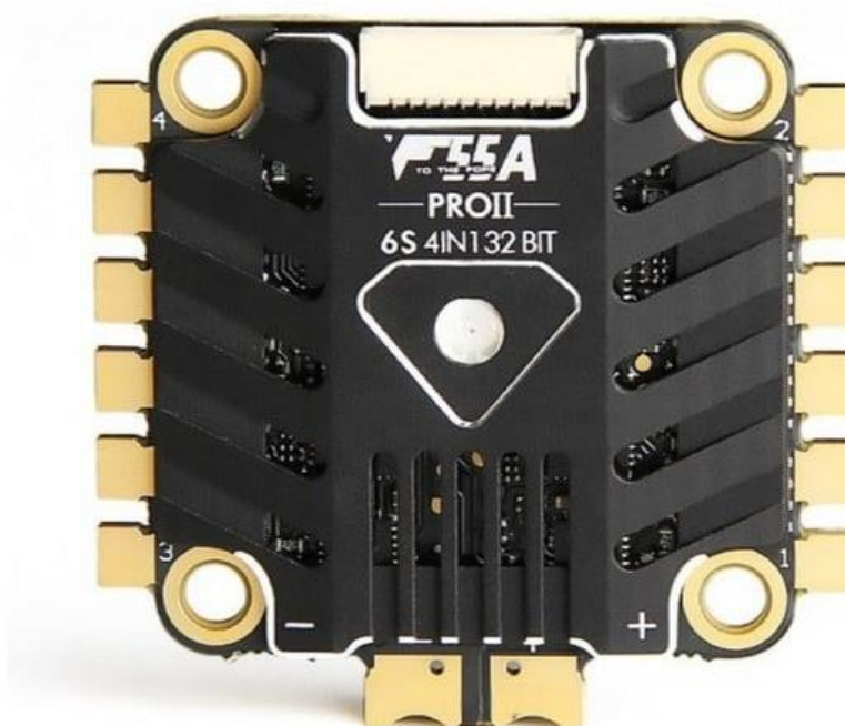
Рисунок 2.4.2.1– Регулятор ходу T-Motor F55A 4-в-1
