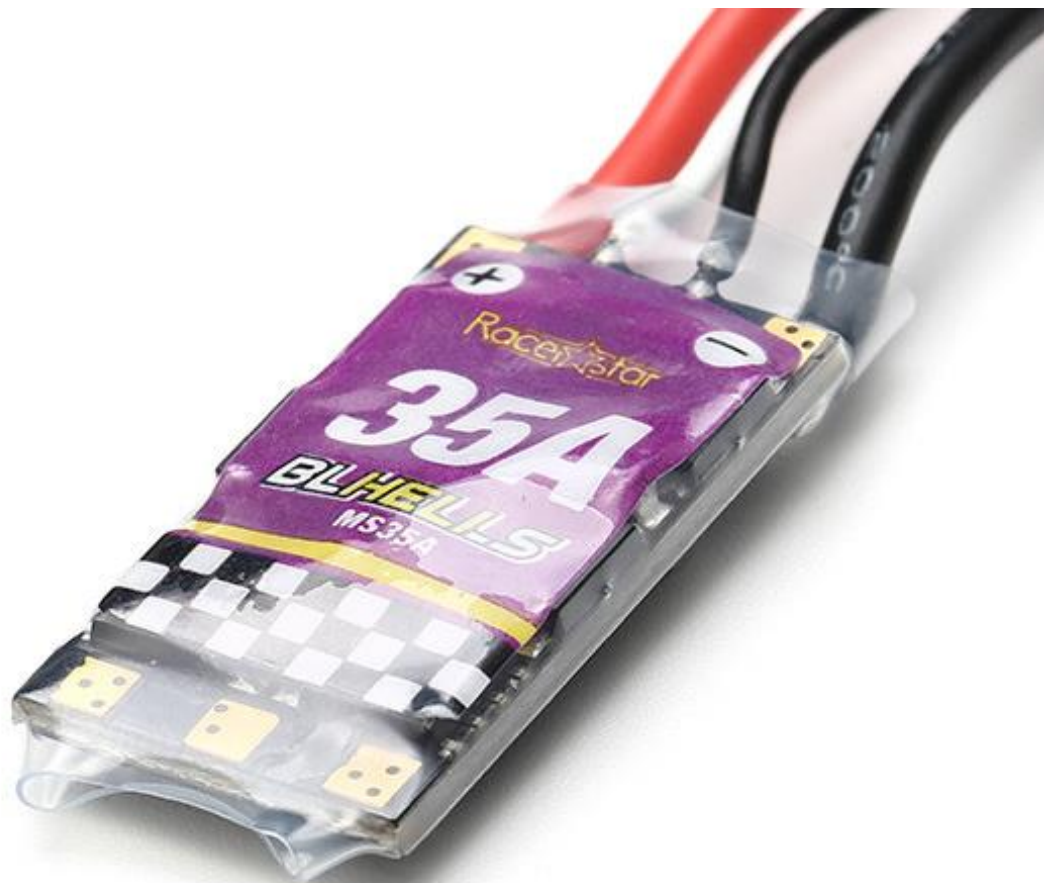
Рисунок 2.4.2.2 – Регулятор ходу MS35A ESC BLHeli-S
