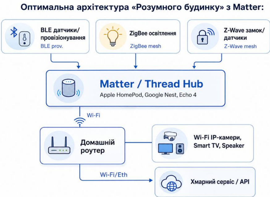
Рисунок 4.3 – Оптимальна архітектура «розумного будинку» з платформою Matter
