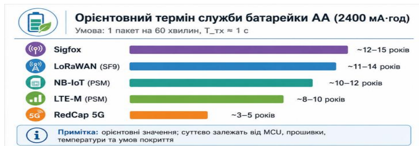
Рисунок 3.10 – Порівняльна оцінка терміну служби батарейки AA для LPWAN-технологій
