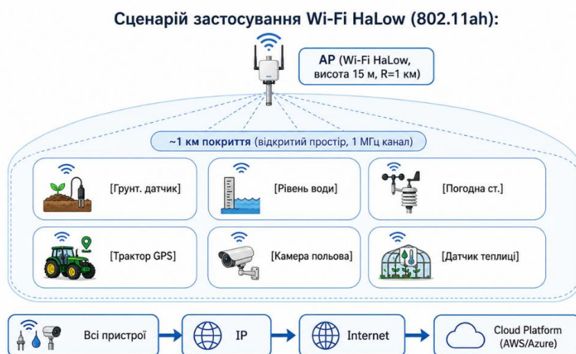
Рисунок 2.9 – Застосування Wi-Fi HaLow (802.11ah) для аграрного IoT
