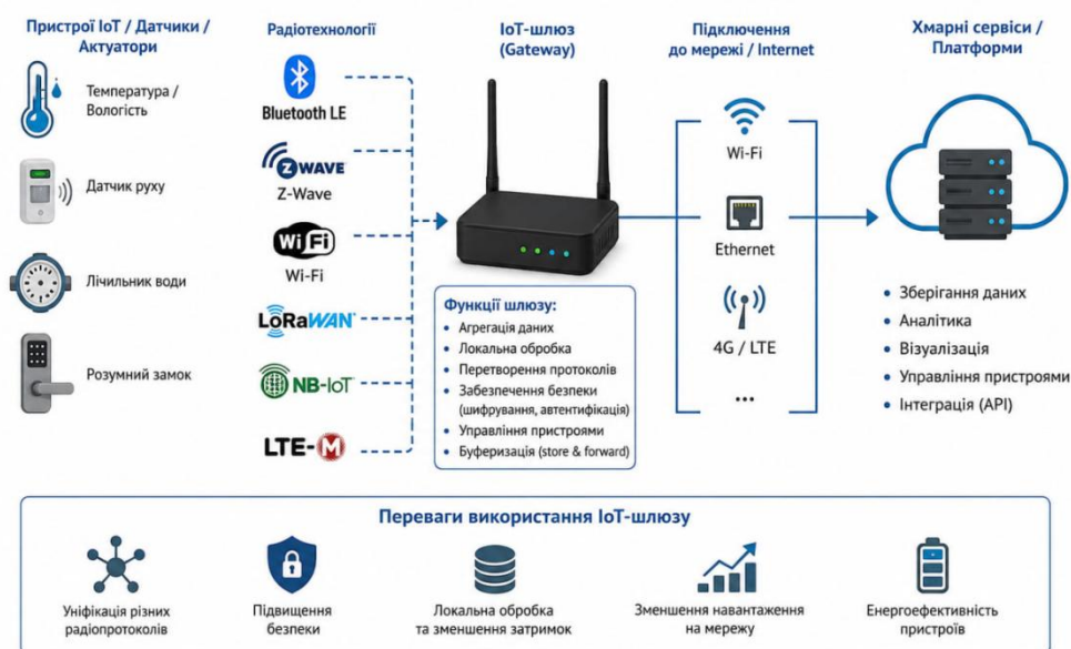
Рисунок 1.5 – Роль IoT-шлюзу як точки конвергенції різних радіотехнологій
