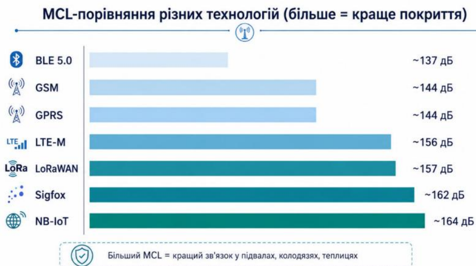
Рисунок 3.6 – Порівняння Maximum Coupling Loss (MCL) LPWAN-технологій
