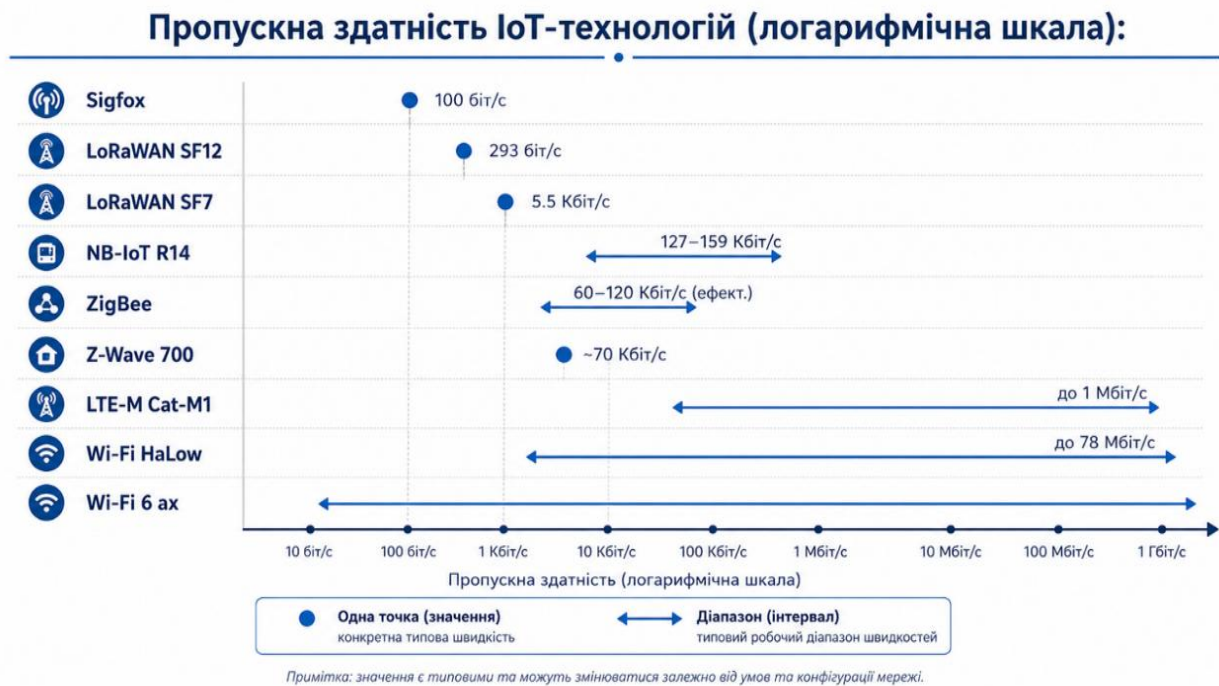
Рисунок 4.1 – Порівняння пропускної здатності IoT-радіотехнологій
