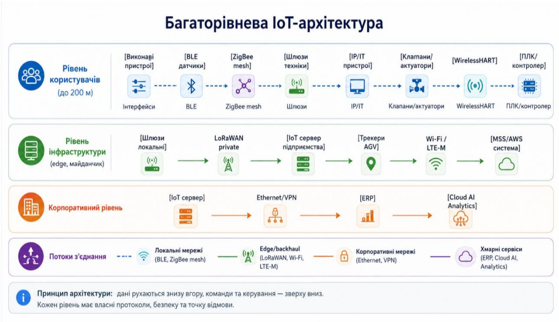
Рисунок 4.4 – Багаторівнева IoT-архітектура промислового підприємства
