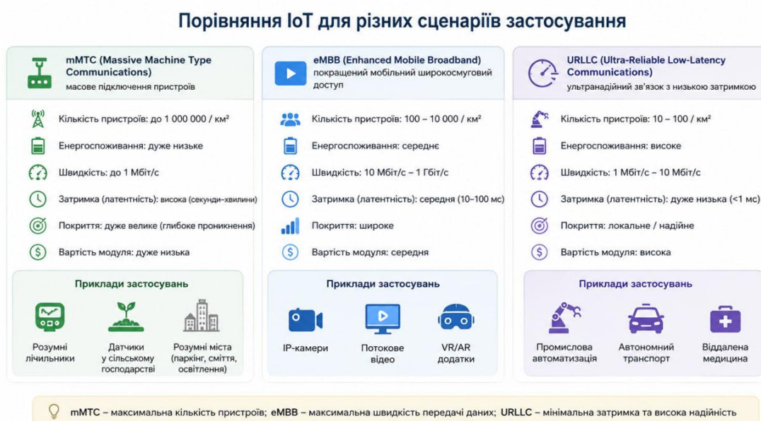
Рисунок 3.8 – Ієрархія 5G IoT-технологій від mMTC до eMBB
