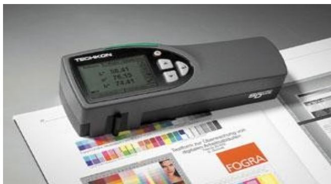
Рис. 2.4 Сенсор RGB хвиль SpectralDens
