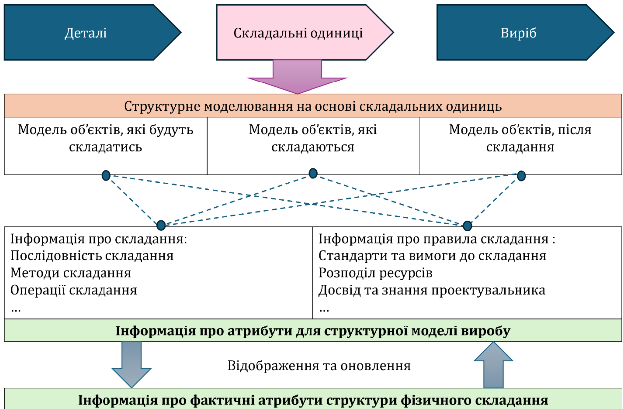
Рисунок 2.14. – Діаграма інформаційної структури ЦД-ПС на основі блоків процесу складання
