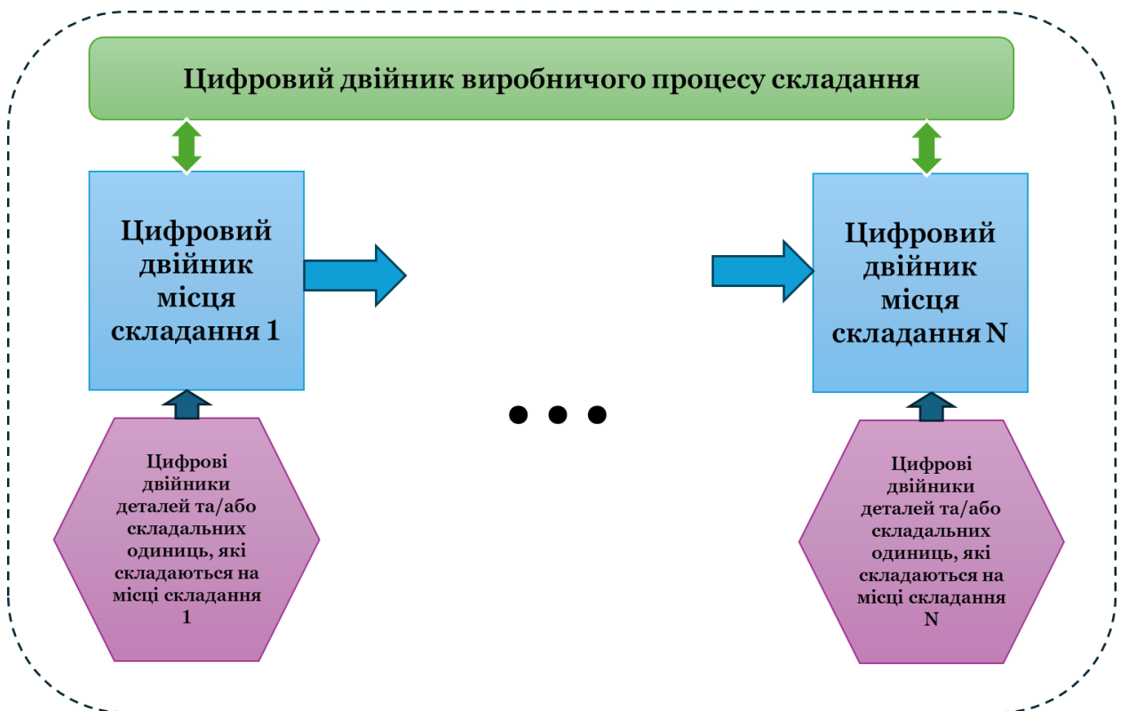
Рисунок 3.2. – Загальний вигляд цифрового двійника складального виробництва
