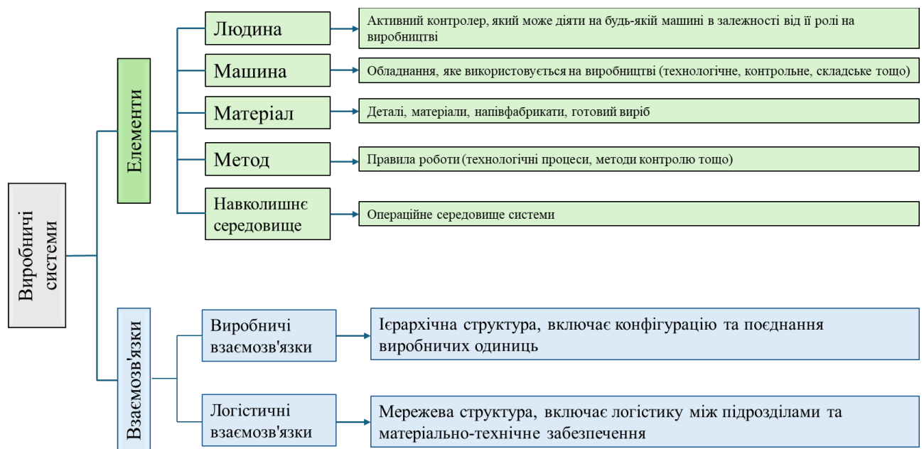
Рисунок 2.7. – Основні елементи та взаємозв'язки, виявлені в фізичних виробничих системах [17]
