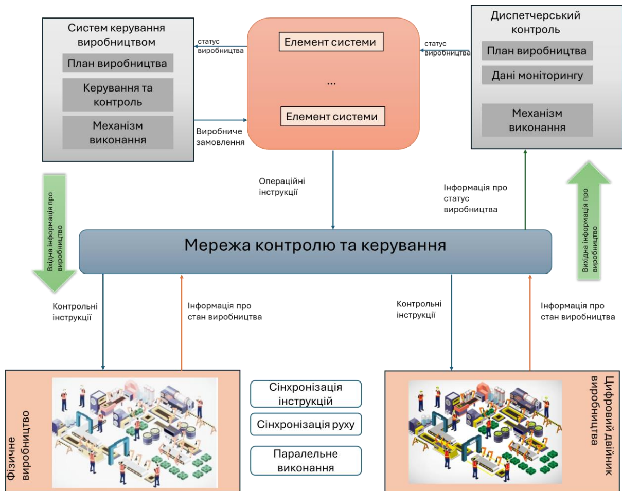
Рисунок 3.4. - Система моніторингу ЦД виробничого процесу складання
