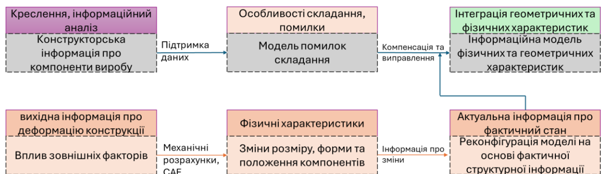
Рисунок 3.3. – Процес злиття геометричної та фізичної інформації про виріб, який складається
