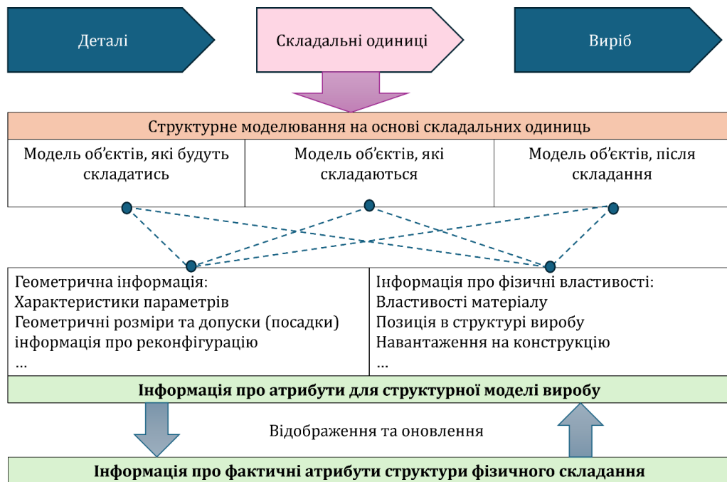
Рисунок 2.12. – Схема інформаційної структури об'єкта складання на основі складальних одиниць
