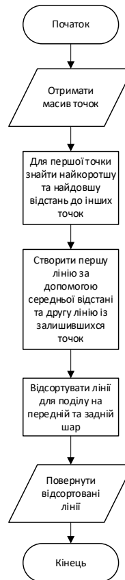
Рисунок 3.2.3 – Діаграма алгоритму створення сортованих масивів точок для кожного шару, які містять в собі інформацію про крайні лінії для армування стіни
