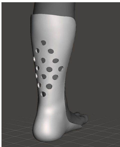
Рисунок 2.10 — Додавання вентиляційних отворів, в середовищі Meshmixer
