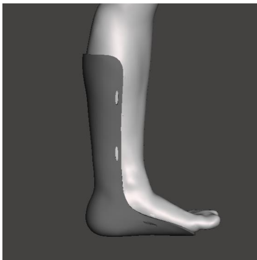
Рисунок 2.4 — Модель з функціональними отворами, в середовищі Meshmixer
