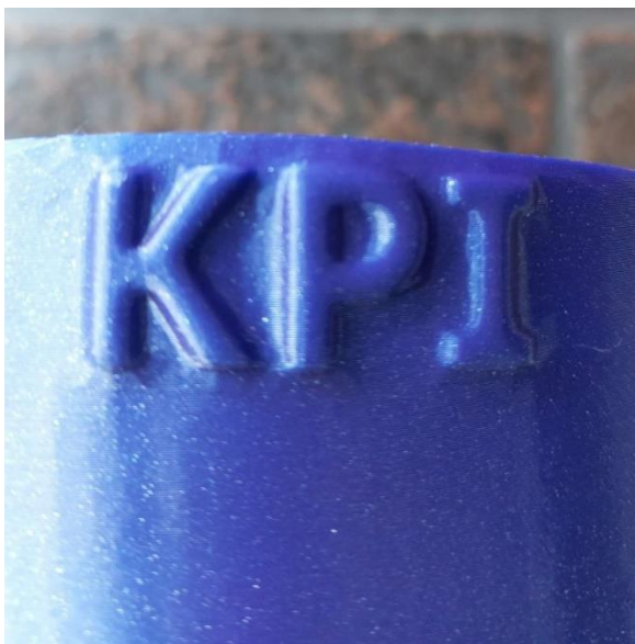
Рисунок 2.19 — Вигляд декоративного елемента на задній стінці надрукованого ортеза
