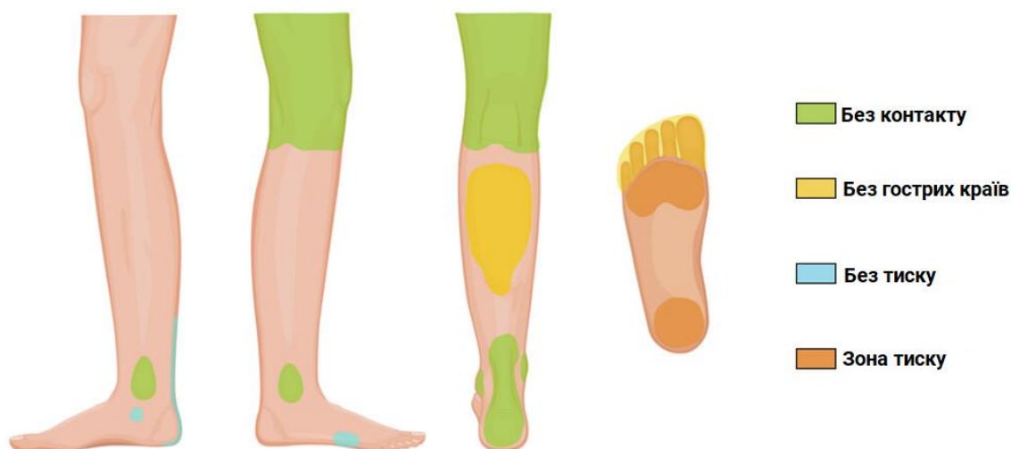
Рисунок 1.5 — Обмеження, що накладаються людським тілом на проектування АФО [1]
