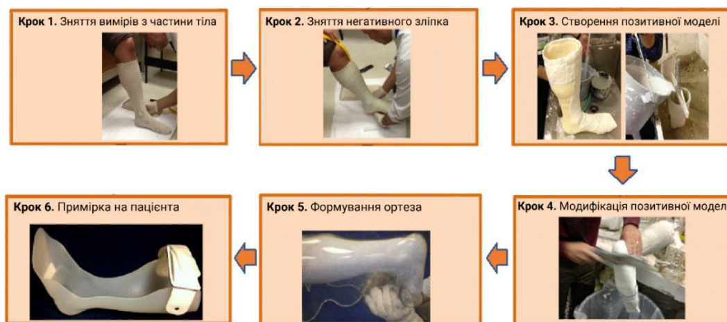
Рисунок 1.6 — Традиційний процес виготовлення ортезів [9].
