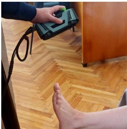
Рисунок 2.1 — Процес 3D-сканування ноги пацієнта
