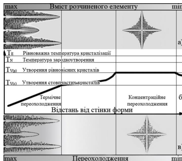
Рисунок 1.9 – Перехід від стовпчастої до рівновісної структури злитку: а) розподіл розчиненого елементу; б) графік залежності температури - відстані від стінки форми; в) температурний градієнт
