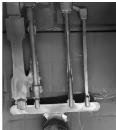
Ж. Відлитий зразок сплаву Al 5 Mg 2 SiMn
