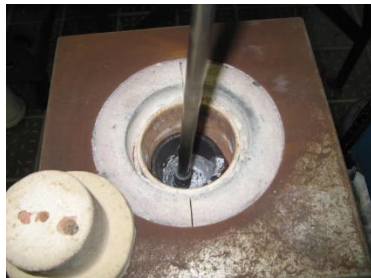
в. Фурма для продування розплаву аргоном і графітошмотний тигель.
