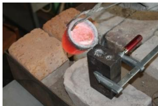
д. Заливання металу в металеву форму
