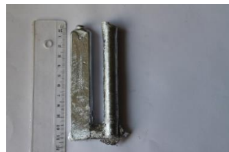
е. Відлитий зразок сплаву \text{Al}_5\text{Mg}_2\text{SiMn}
