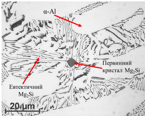
в) Мікроструктура M59
