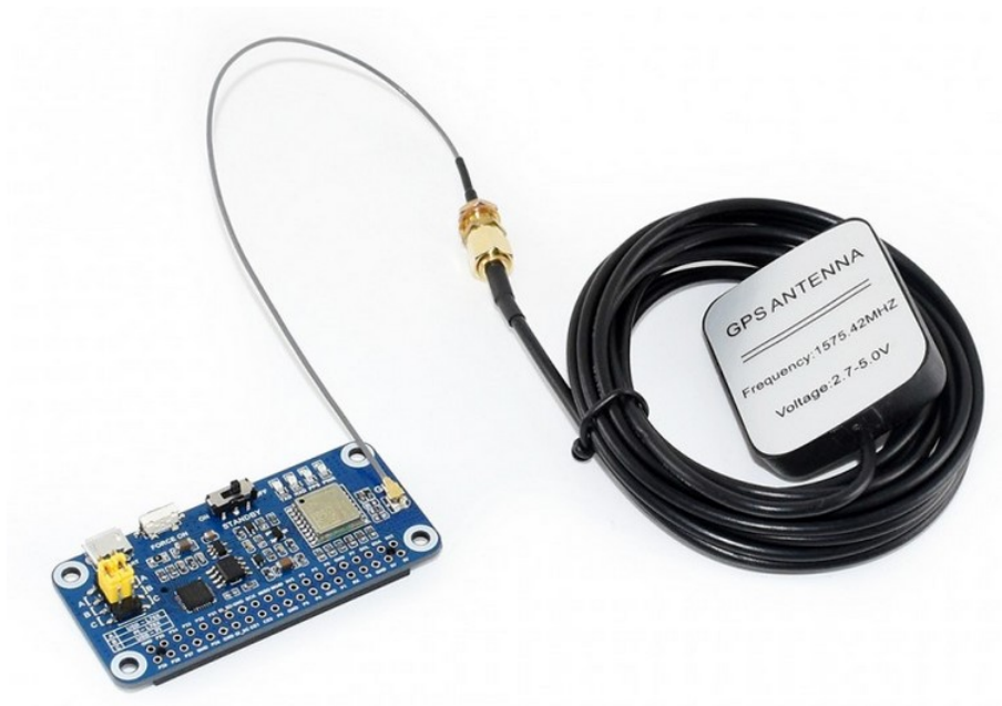
Рисунок 2.2.1 – Модуль L76X Multi-GNSS HAT від Waveshare з антеною
