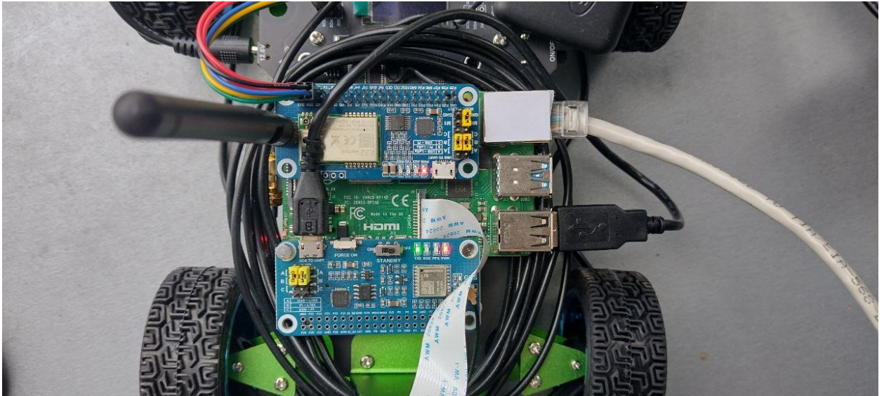
Рисунок 3.1.2 – Роботизована платформа, підключення кабелів та перемичок
