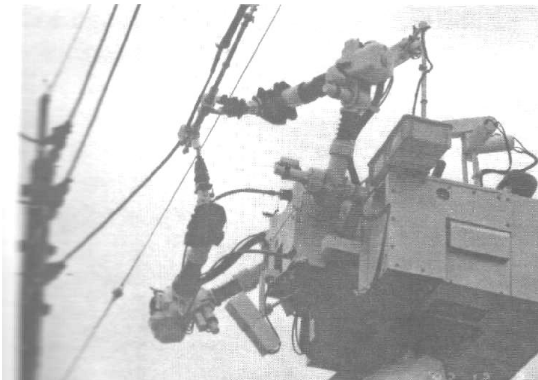
Рис. 5.4. Загальний вигляд маніпулятора, що керується з землі
