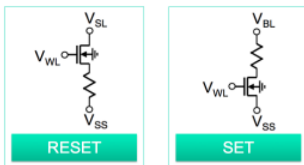
Рисунок 1.6 — Схема зміщення для режиму стирання та запису [4]
