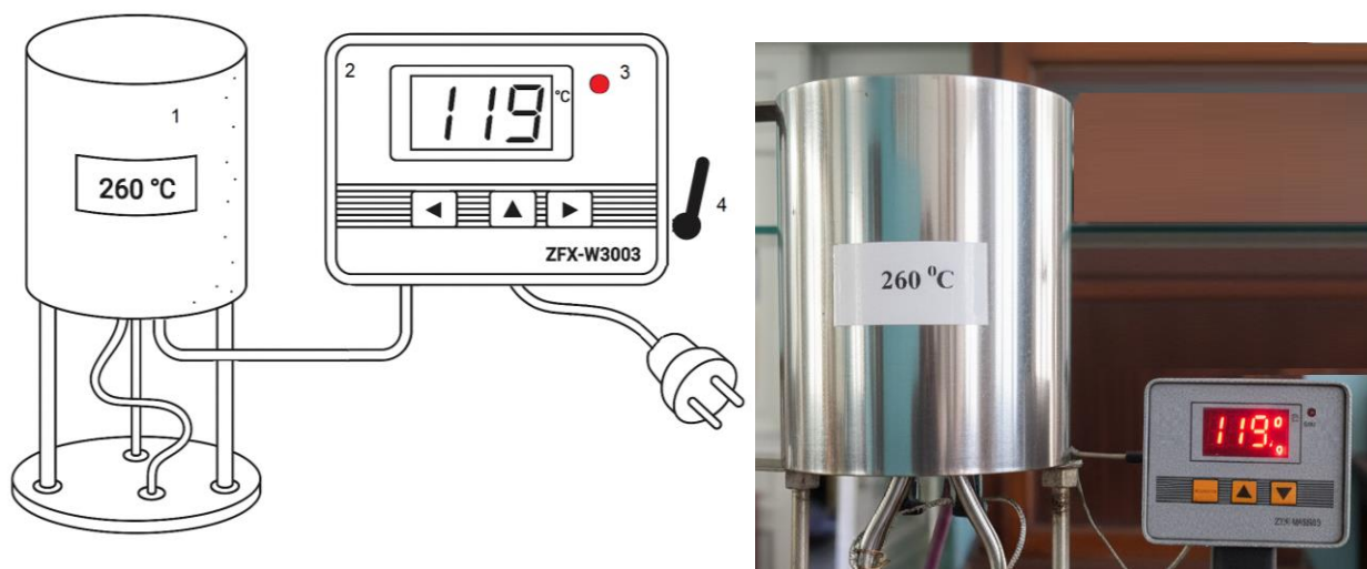
Рисунок 3.14 – Схема лабораторної установки 2: 1 – піч, 2 – релейний регулятор, 3 – світлодіод, 4 – перемикач
