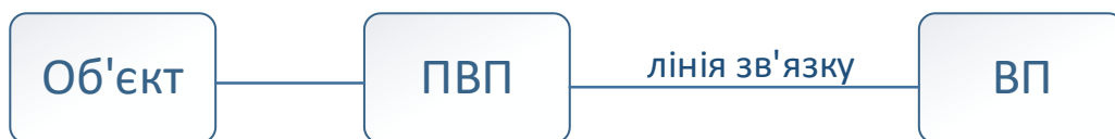
Рисунок 1.1 – Місце первинного вимірювального перетворювача у ланцюгу перетворення: ПВП – первинний вимірювальний перетворювач; ВП – вторинний прилад
