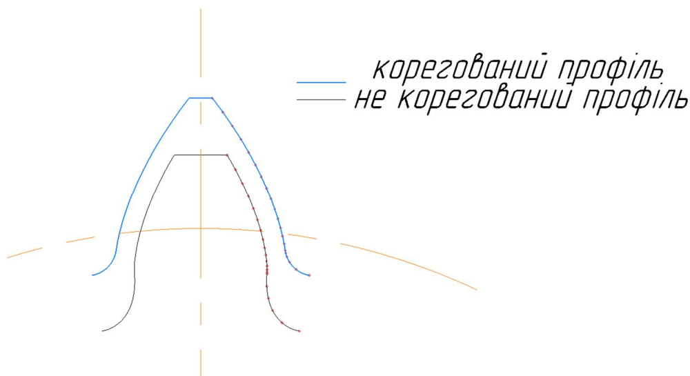
Рисунок 2.1. कोरोгований та не कोरोгований профіль зубця шестерні
