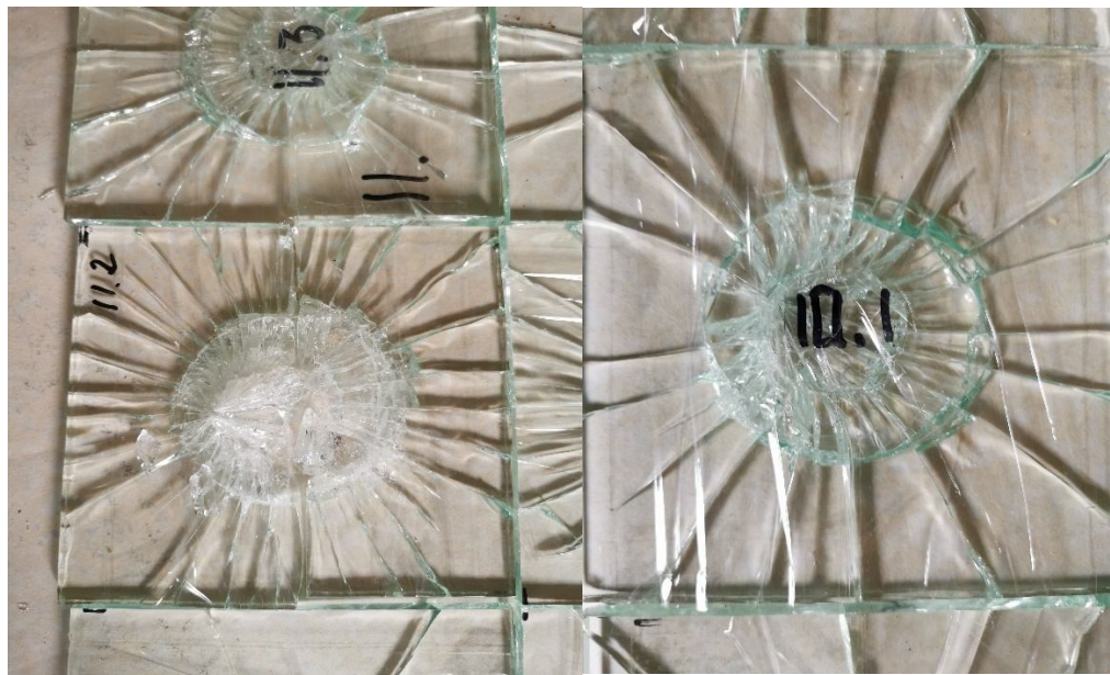
Рисунок 7.7. Типовий характер руйнування зразків флоат-скла при вісесиметричному згині
