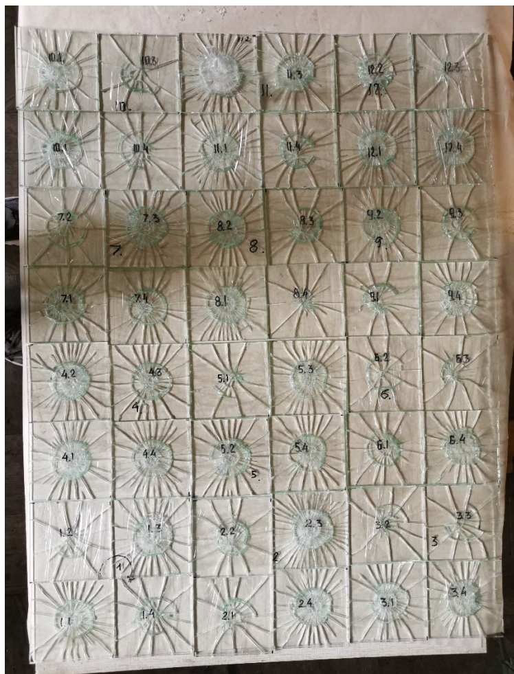
Рисунок 7.9. Загальний вигляд зразків, вирізаних з дослідженої пластини флоат-скла, після проведення випробувань
