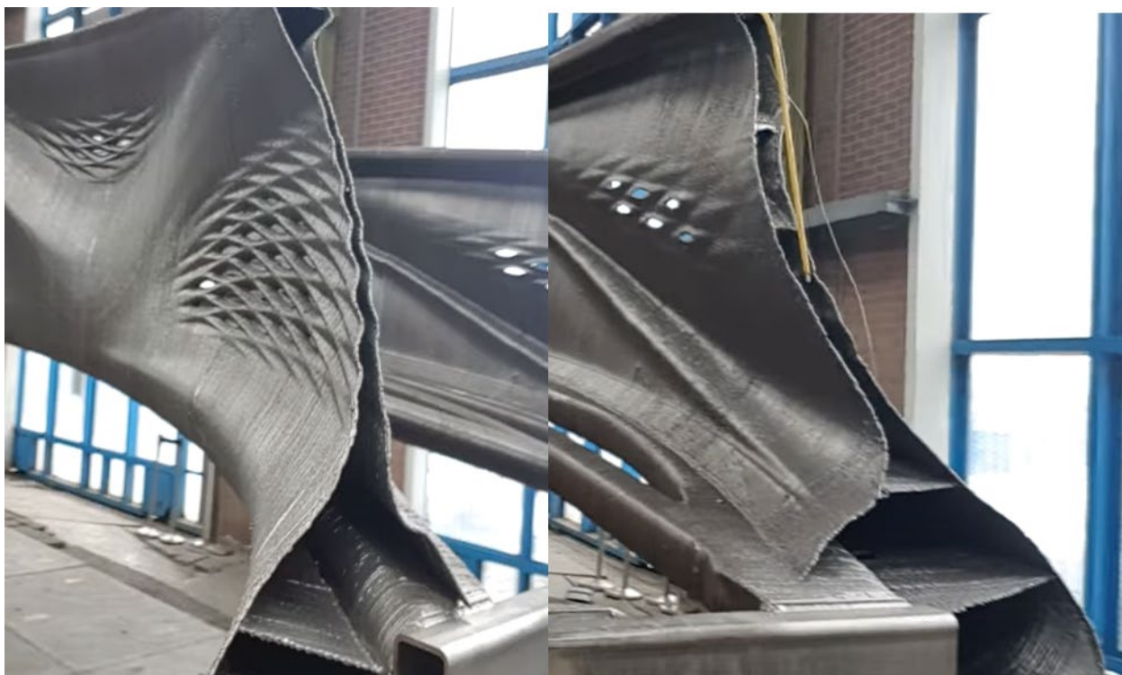
Рисунок 21 - Виготовлення пішохідного мосту методом Wire-Arc Additive Manufacturing
