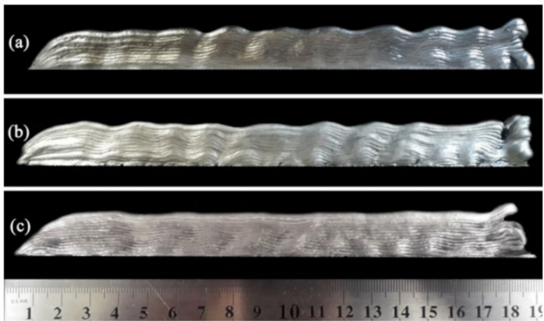
Рисунок 34 WAAM 14-шарові стінки, побудовані з високою швидкістю наплавлення: (a) 185 см/хв; (b) 180 см/хв; і (c) 175 см/хв (середній струм 81 А і напруга 12,5 В)
