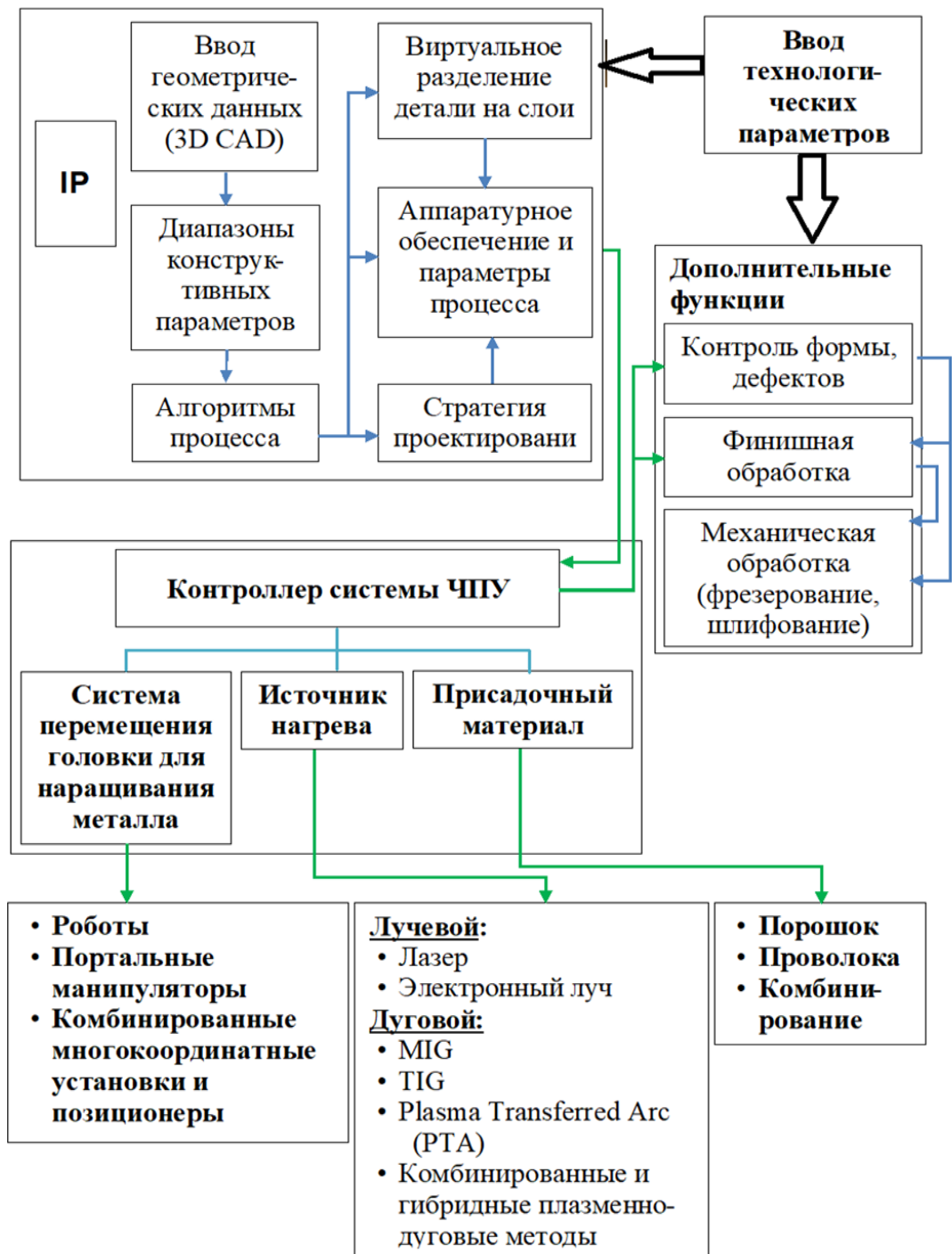
Рисунок 10 - Принципова апаратно-структурна схема процесів отримання об'ємних металевих виробів пошаровим адитивним нарощуванням на основі зварювальних технологій
