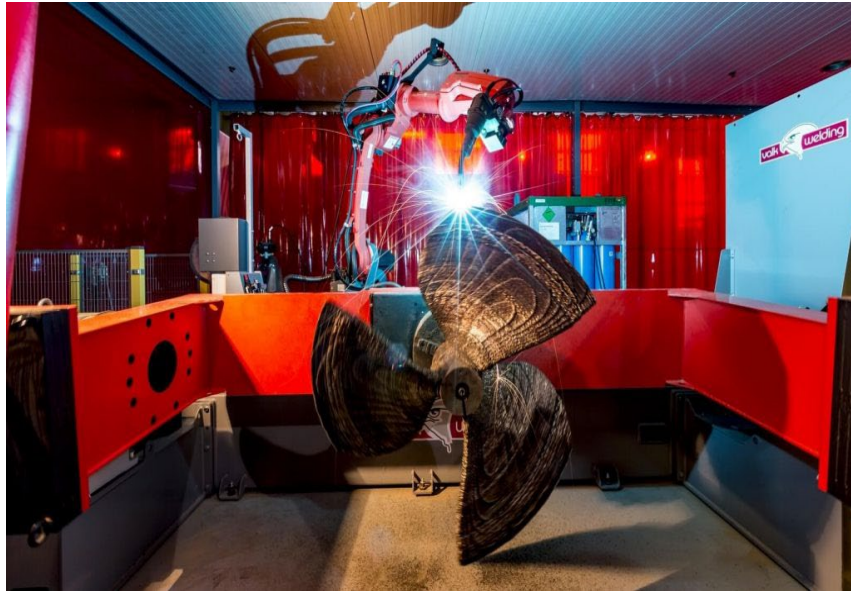
Рисунок 16 - Процес виготовлення гвинта WAAMpeller методом Wire-Arc Additive Manufacturing.
