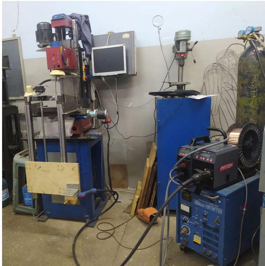
Рисунок 53 – Розроблене обладнання для адитивного виробництва способом MAG
