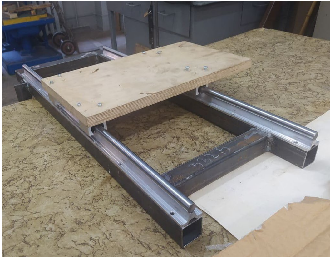
Рисунок 44 – Розроблений кронштейн з закріпленими направляючими та пластиною з каретками
