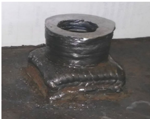
Рисунок 32 Наплавлений зразок, що пройшов механічну обробку верхньої площини
