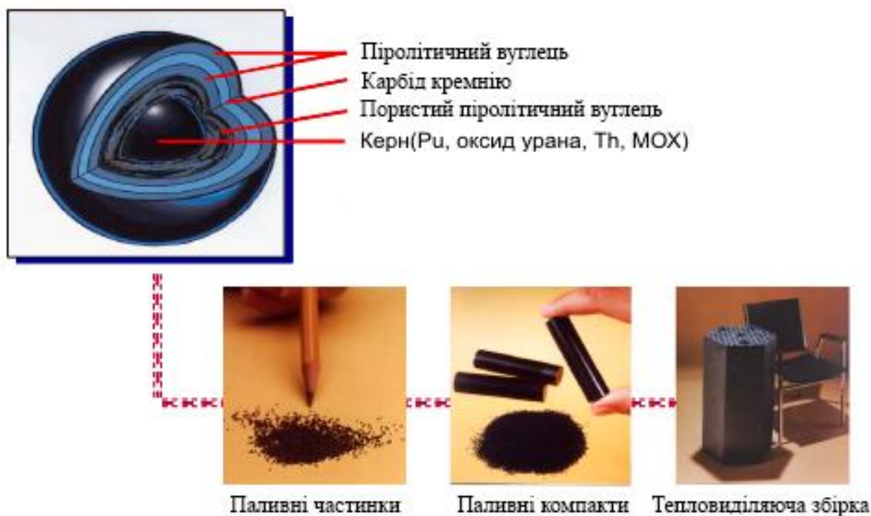
Рисунок 1.7 – Схема формування тепловиділяючої збірки високотемпературного гелієвого реактора
