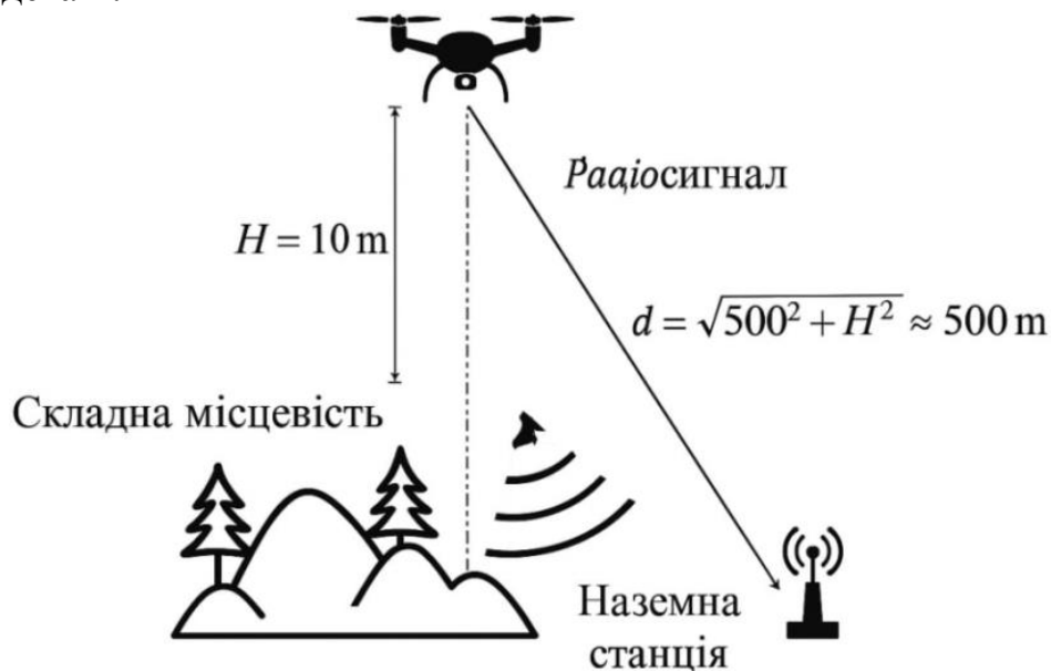
Рис. 1. Схема зв'язку між дистанційно-керованим повітряним апаратом і наземною станцією
