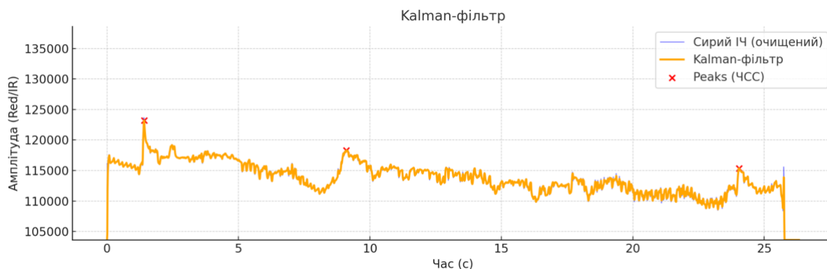
Рис. 2.7 Фільтрація ІЧ сигналу Kalman-фільтром Калмана. Синя лінія — сирий ІЧ сигнал, помаранчева — результат Kalman-фільтрації, червоні хрестики — піки ЧСС.
