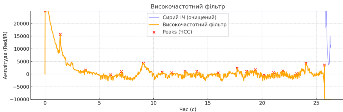
Рис. 2.5 Фільтрація ІЧ сигналу високочастотним фільтром. Синя лінія — сирий ІЧ сигнал, помаранчева — результат високочастотного фільтра, червоні X — піки ЧСС.
