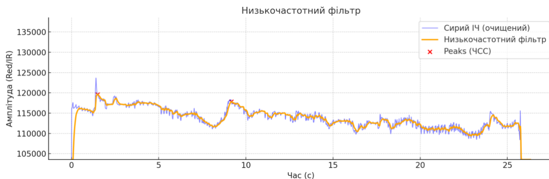
Рис. 2.4 Фільтрація ІЧ сигналу низькочастотним фільтром. Синя лінія — сирий ІЧ сигнал, помаранчева — результат низькочастотного фільтра, червоні X — піки ЧСС.
