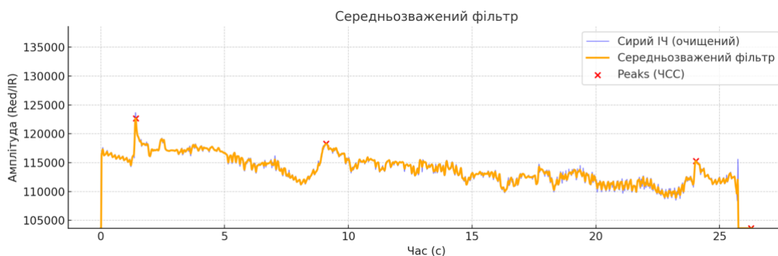
Рис. 2.6 Фільтрація ІЧ сигналу середньозваженим фільтром. Синя лінія — сирий ІЧ сигнал, помаранчева — згладжений сигнал середньозваженим фільтром, червоні X — піки ЧСС.
