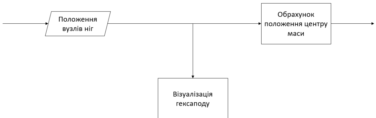
Рисунок 2.23 Схеми роботи блоків обчислення положення центру мас та візуалізації гексаподу
