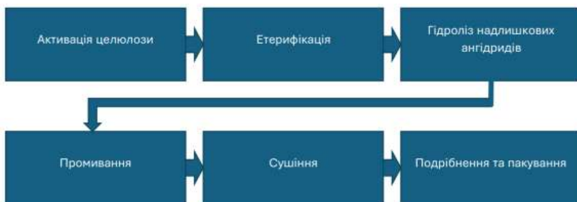
Рисунок - Технологічна схема виробництва ацетобутирату целюлози
