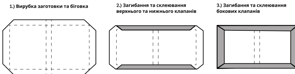
Рисунок 2.10 – Типова конструкція інтегральної палітурки
