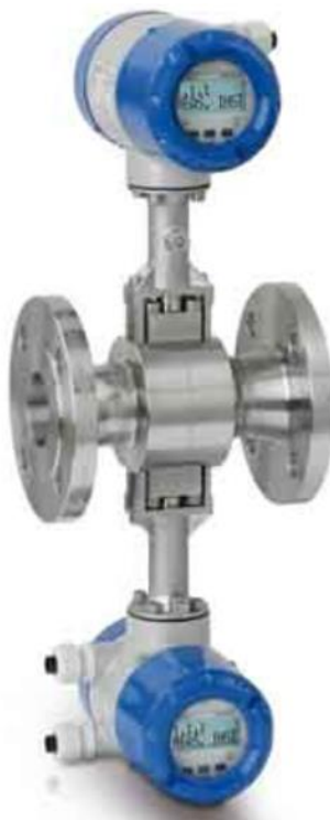
Рисунок 1.29 – Фланцевий монтаж вихрового витратоміру з редундантним (резервованим) виконанням з двома паралельними ВК (два сенсори і два конвертери в два вихідні сигнали).
