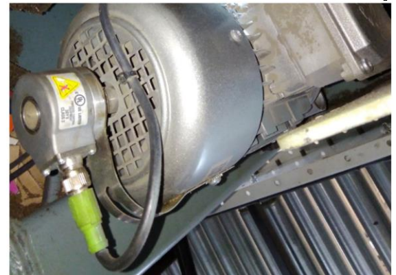
Рисунок 1.44 – Монтаж енкодерів на двигуні
