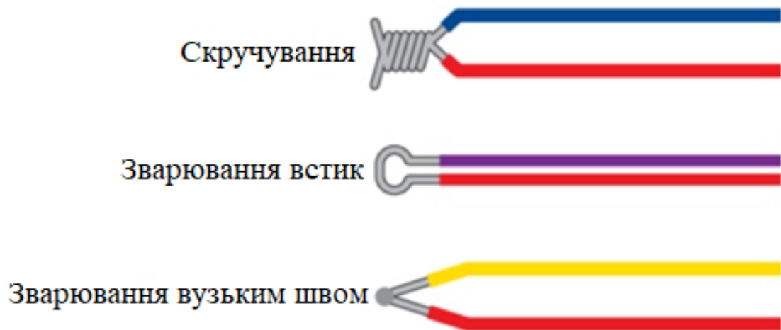
Рисунок 1.12 – Способи виготовлення гарячого спаю
