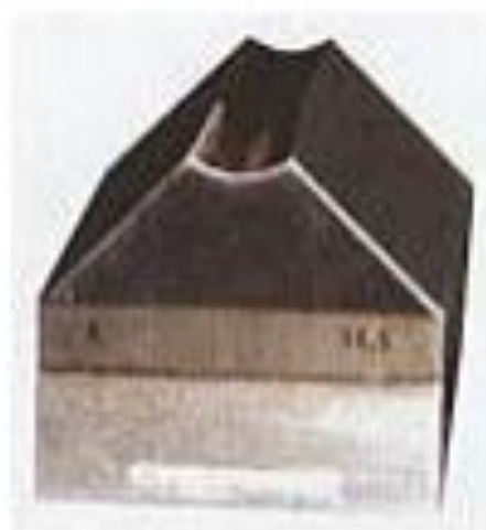
Рис.1.12 Один з бійків ковальської машини, що перетворює сталеву трубу в ствол
