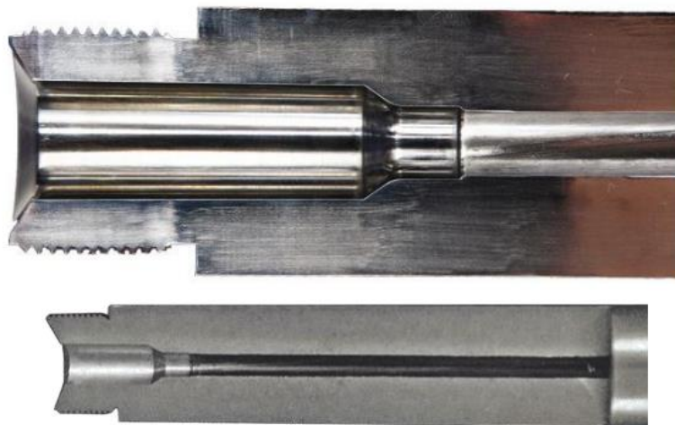
Рис.1.7 Розріз ствола з патронником.
