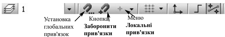
Рис.2.5. Кнопки керування прив'язками на Панелі поточного стану .
