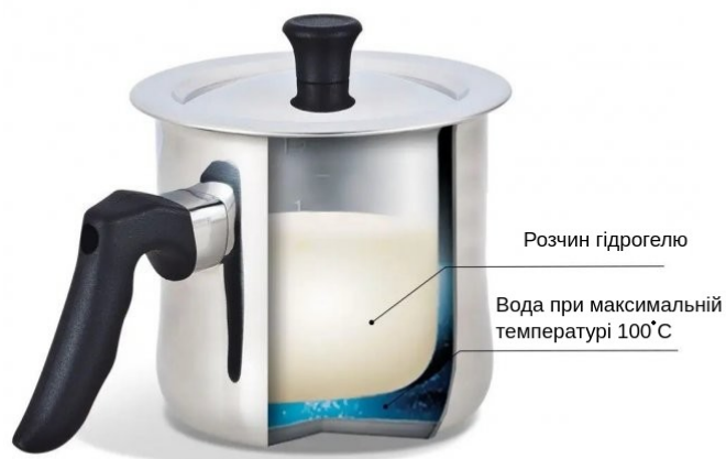
Рисунок 2.2 — Парова баня для приготування гідрогелевого розчину
