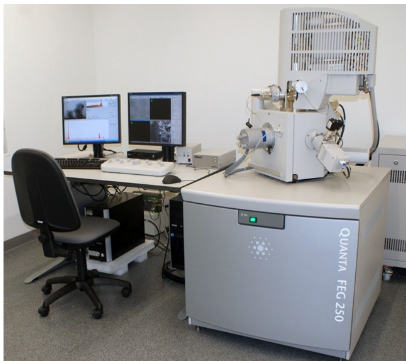
Рис. 2.11 — Скануючий електронний мікроскоп Quanta FEG 250 [35]
