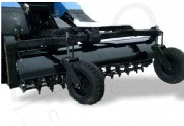
Рисунок 2.8 - Сколювач льоду БЛ-2500 [6]
