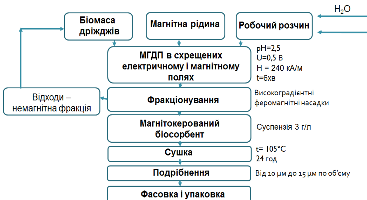
Рисунок 6.1 – Технологічна схема отримання магнітоміченого біосорбенту
