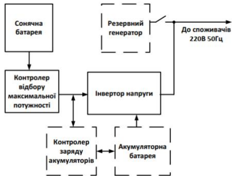
Рисунок 1.2 – Загальна схема сучасної автономної сонячної фотоелектричної системи
