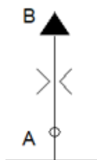
Рис. 3.3 Для імітації форсунки використовуємо Variable orifice
