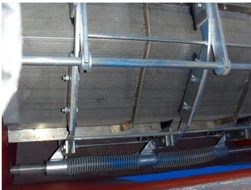
Рис 2.2 Фото сітки та щіток з рухомим механізмом центрифуги
