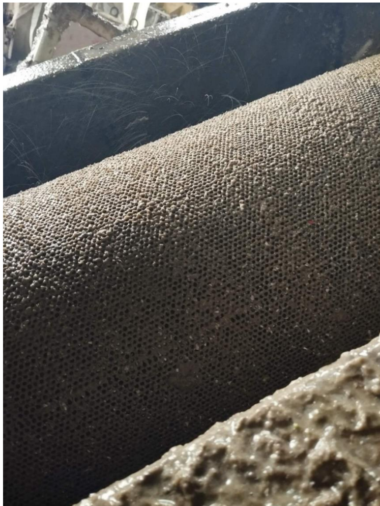
Рис. 1.11 Забруднена сітка барабану центрифуги.
