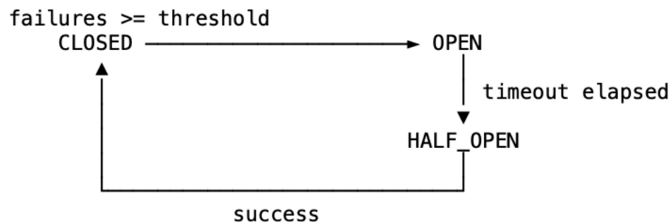
Рисунок 2.3 – Послідовність роботи автоматичного вимикача
