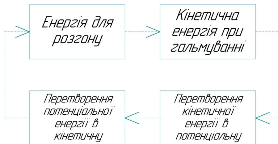
Рисунок 2.10. Алгоритм перетворення видів енергії при роботі системи накопичення стиснутого повітря
