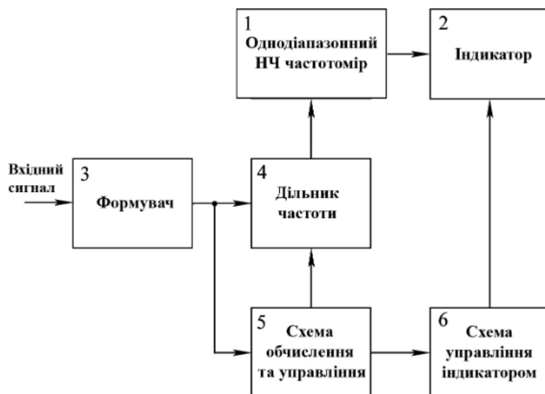
Рисунок 2.5 — Структурна схема вимірювача частоти електричного сигналу
