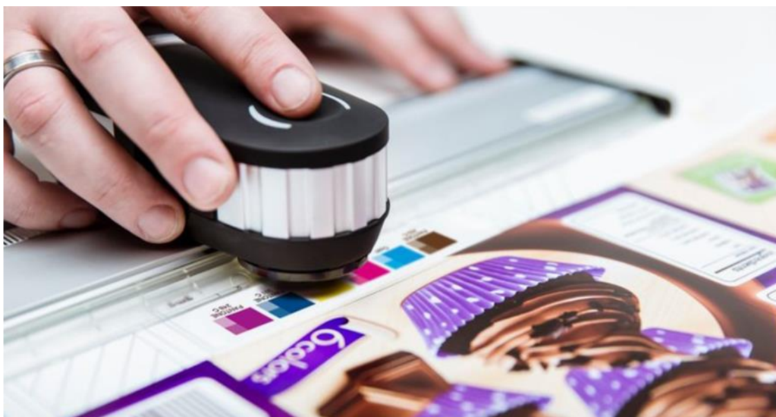
Рис. 3.2.5. Системи автоматизованого контролю кольору GMG OpenColor
