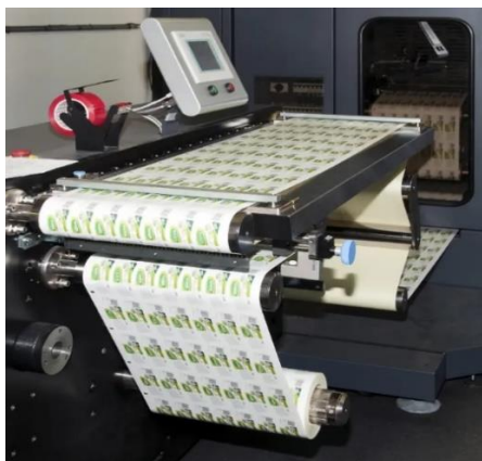
Рис. 3.2.1. Системи комп'ютерного розпізнавання дефектів друку AVT Helios
