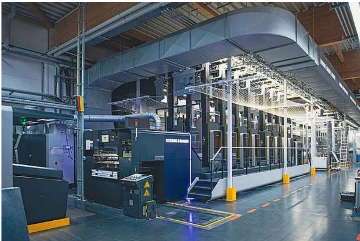
Рис. 2.2.1. Середньоформатна машини Rapida 106 X інтегрована з автоматичними системами логістики друкарських форм.
