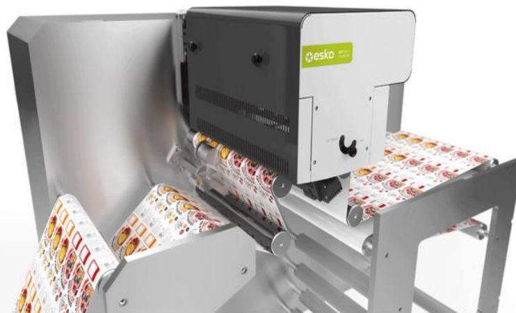
Рис. 3.2.1. Системи комп'ютерного розпізнавання дефектів друку AVT Helios
