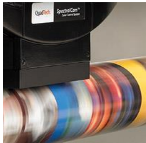
Рис. 3.2.2. Системи комп'ютерного розпізнавання дефектів друку QuadTech
