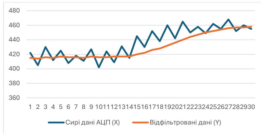
Рисунок 2.18 - Порівняння сирих та відфільтрованих даних АЦП сенсора MQ-135
