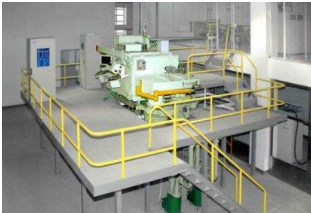
Рисунок 1.8- Зовнішній вигляд промислової електронно-променевої установки Л5 для одержання паро фазних конденсатів на основі міді
