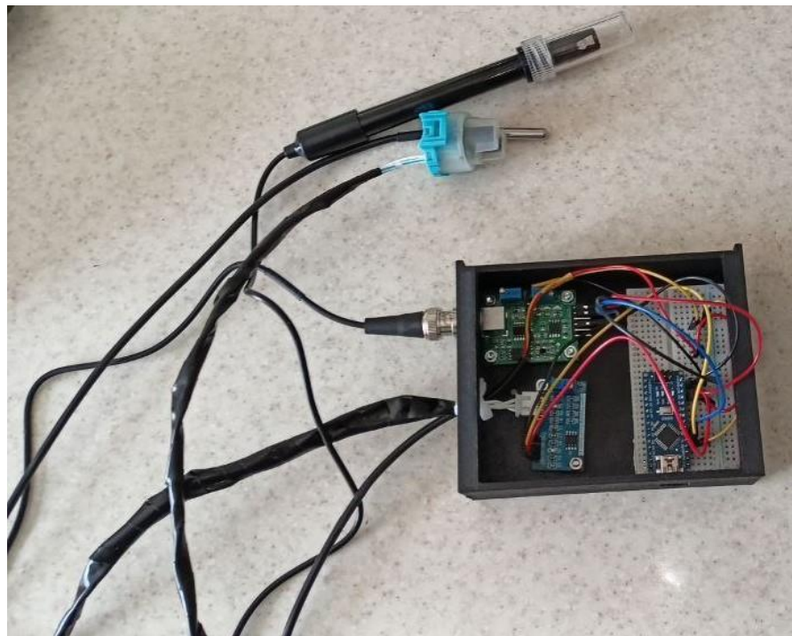
Рис.2.14 Макет АСКЯВ всередині корпусу з підключенням плат
