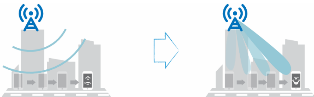
Рисунок 1.10 – Beamforming у системах MIMO [3]
