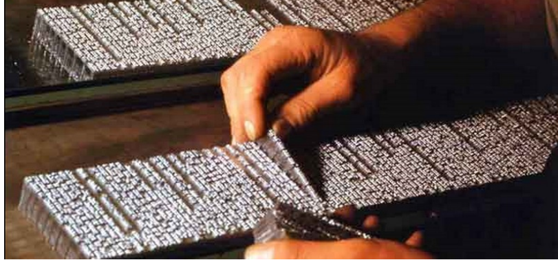
Рис. 4. Загальний вигляд відлитого рядка (а) та процес складання шпальти набору (б)
