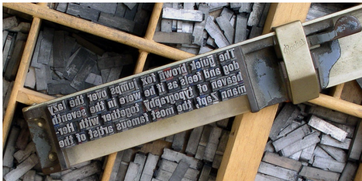
Рис. 3. Верстатка для ручного складання тексту(а) та набірна каса (б)
