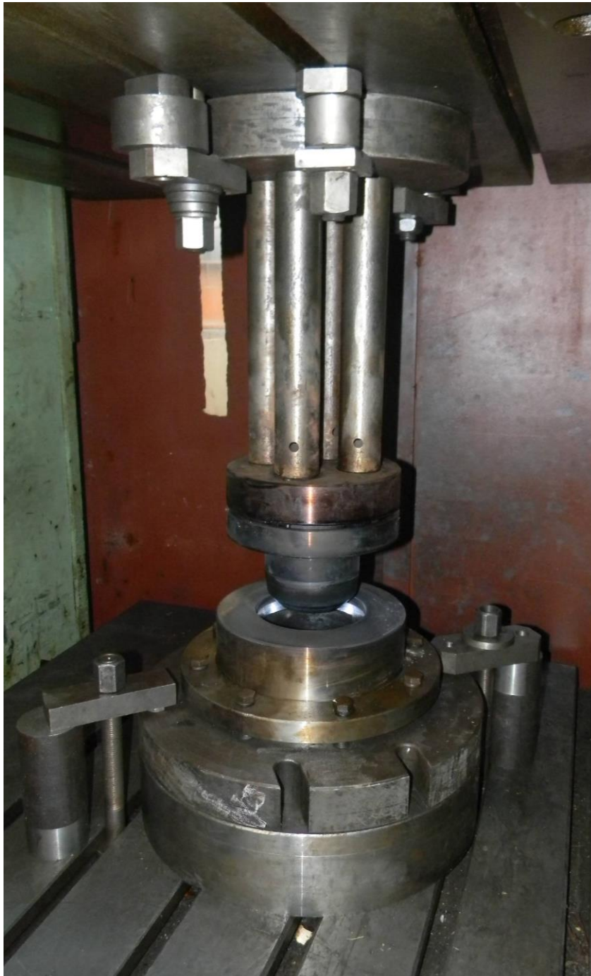
Рис.4.1. Експериментальний штамп на гідравлічному пресі ДБ 2436 зусиллям 4 МН
