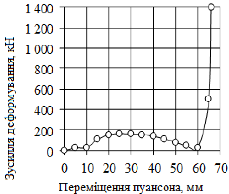
Рис. 3.5. Залежність зусилля деформації від переміщення пуансона.
