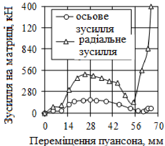
Рис. 3.6. Залежності осьового і радіального зусилля на матриці від переміщення пуансона
