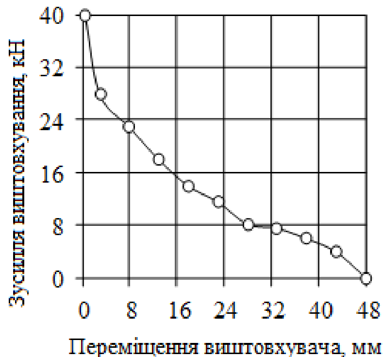
Рис. 3.7. Залежність зусилля виштовхування виробу з матриці від переміщення пуансона
