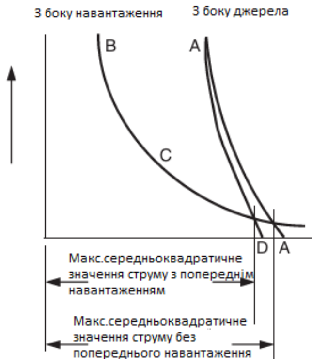
Рисунок 2.1 – Часо-струмові характеристики для координації роботи запобіжників
