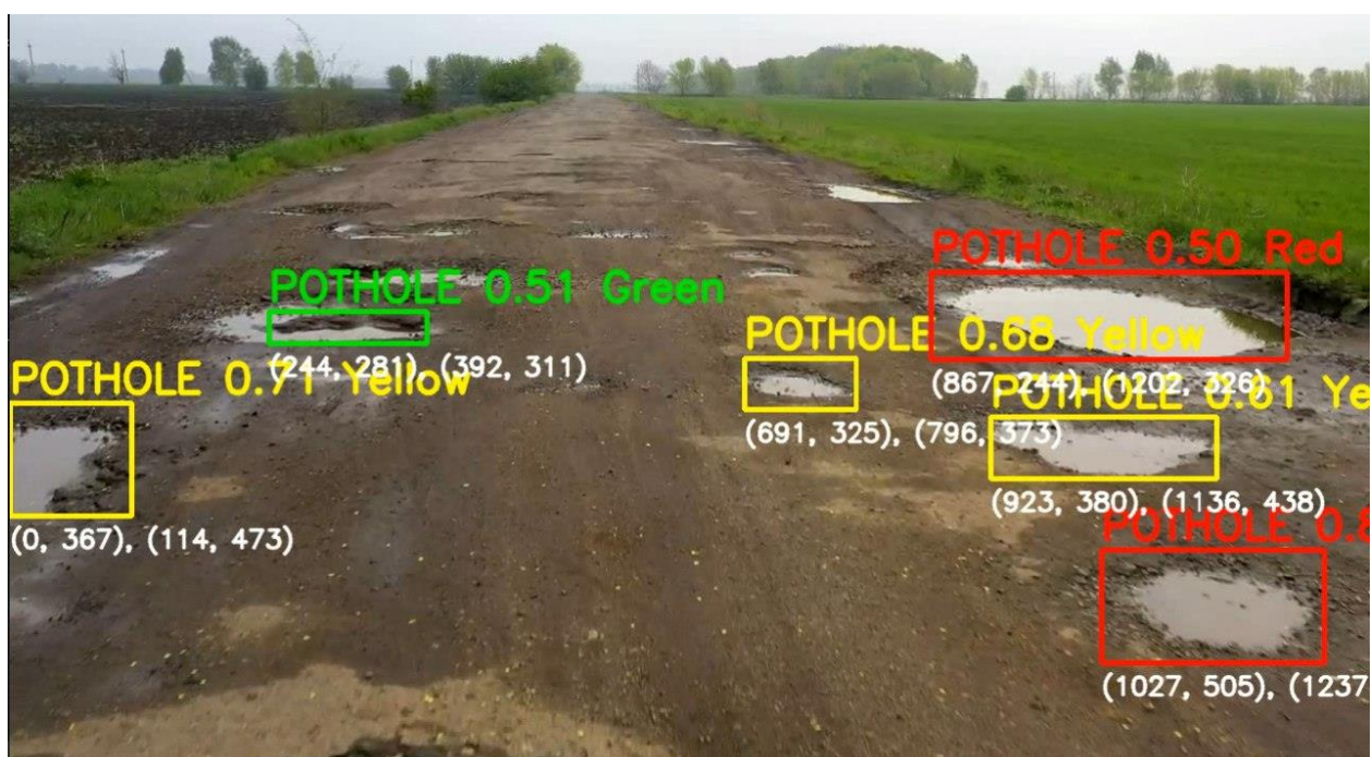
Рисунок 3.12 – Результат роботи для комбінованого покриття
