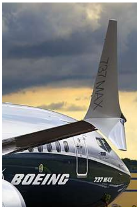
Рисунок 2.4. Пристрій з роздвоєною закінцівкою крила
