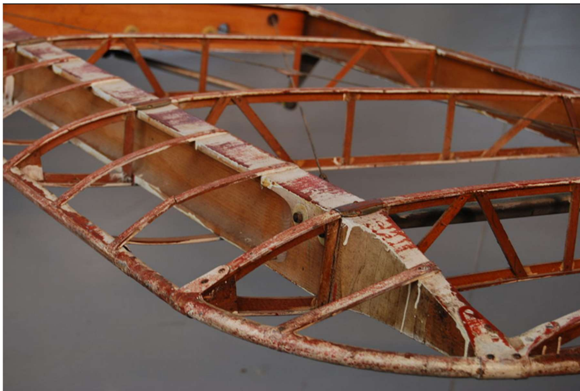
Рисунок 3.5 Крило без обшивки з нервюрами і проходящим через них лонжероном
