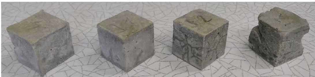
Рис Б.1 Зразки з форміатом кальцію на 168 добу у воді. Вміст добавки з ліва на право відповідно: 0 %; 1 %; 3 %; 5%.
