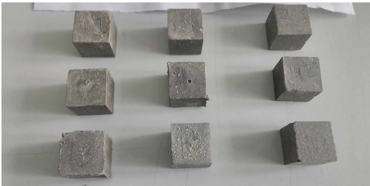
Рис 4.14. Порівняння вигляду зразків з добавками ефірів целюлози на 168 добу (після перебування у середовищі MgSO_4 ). З ліва на право: НВ, СВ, ВВ; з гори вниз - 0,25, 0,50, 0,75 мас. % відповідно.
