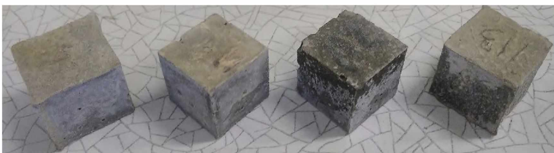
Рис Б.2 Зразки з версататом (Neolith 4400) на 168 добу у воді. Вміст добавки з ліва на право відповідно: 0 %; 1 %; 3 %; 5%.
