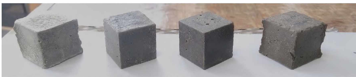
Рис 4.10. Стан зразків з метил гідроксиетил целюлозою на 168 добу (зразки перебували у середовищі MgSO_4 ). З ліва на право: Цемент, HB I, HB II, HB III
