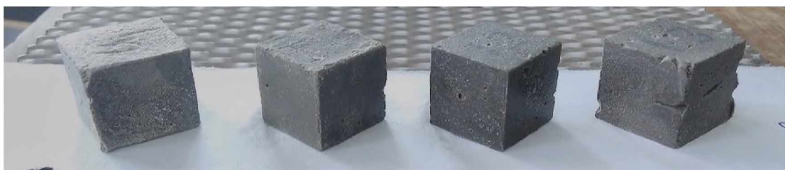
Рис 4.11. Стан зразків ефірів целюлози на 168 добу (зразки перебували у середовищі CaSO_4 ). З ліва на право: Цемент, HB I, HB II, HB III
