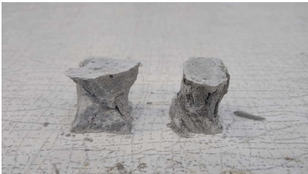
Рис. 4.16. Зразки з метил гідроксиетил целюлозою середньої та високої в'язкості. Типове Х-подібне руйнування правильно приготовленого зразка (лівий зразок) та аномальне (правий зразок).
