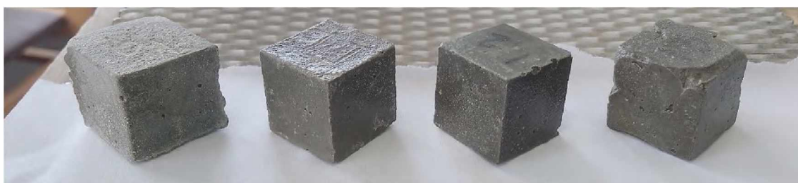
Рис 4.9. Стан зразків з метил гідроксиетил целюлозою на 168 добу (зразки перебували у середовищі Na_2SO_4 ). З ліва на право: Цемент, HB I, HB II, HB III
