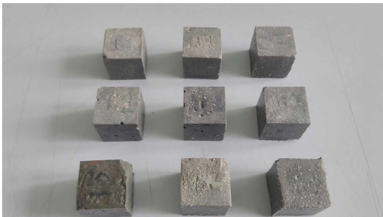
Рис 4.12. Порівняння вигляду зразків з добавками ефірів целюлози на 168 добу (після перебування у воді). З ліва на право: НВ, СВ, ВВ; з гори вниз - 0,25, 0,50, 0,75 мас. % відповідно.
