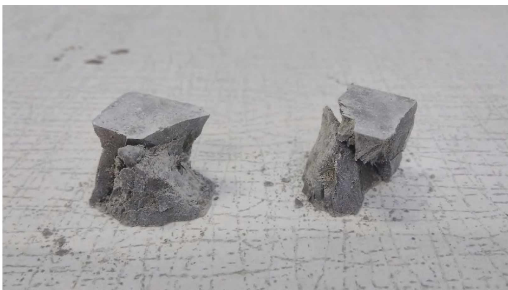
Рис. 4.17 Зразки з метил гідроксиетил целюлозою низької (лівий зразок) та високої в'язкості (правий зразок). Типове Х-подібне руйнування правильно приготовлених зразків.
