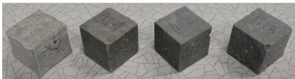
Рис. Б.9 Зразки з вініл-акриловим сополімером (Neolith 6700) на 168 добу у середовищі MgSO_4 . Вміст добавки з ліва на право відповідно: 0 %; 1 %; 3 %; 5%.
