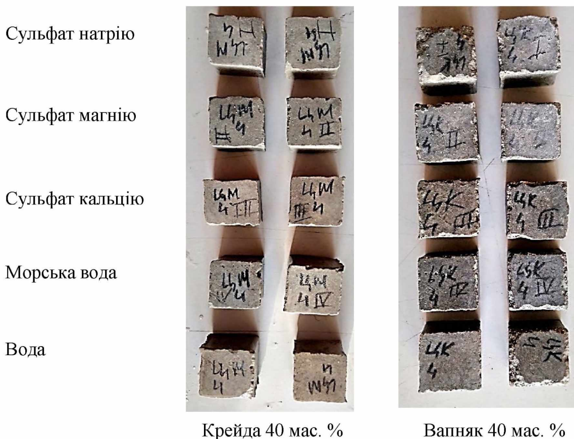
Рисунок 4.2 Зовнішній вигляд зразків цементів з 40 мас.% крейди і вапняку у віці 180 діб
