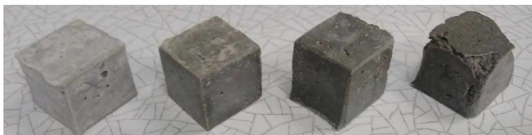
Рис. Б.10 Зразки на 168 добу у середовищі CaSO_4 . Вміст добавки 1 мас. %. З ліва на право відповідно: Цемент; Форміат кальцію, версатат (Neolith 4400); вініл-акриловий сополімер (Neolith 6700).
