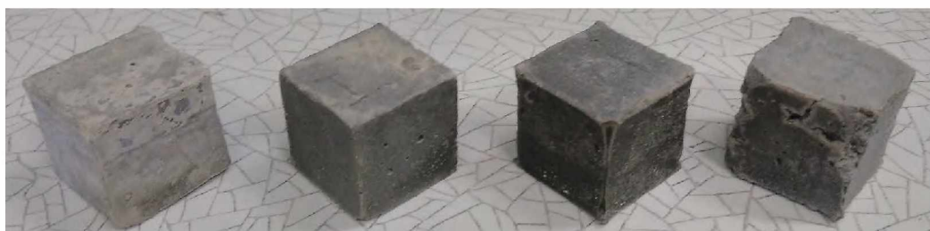
Рис. Б.7 Зразки з форміатом кальцію на 168 добу у середовищі MgSO_4 . Вміст добавки з ліва на право відповідно: 0 %; 1 %; 3 %; 5%.
