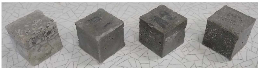
Рис. Б.5 Зразки з версататом (Neolith 4400) на 168 добу у середовищі Na_2SO_4 . Вміст добавки з ліва на право відповідно: 0 %; 1 %; 3 %; 5%.
