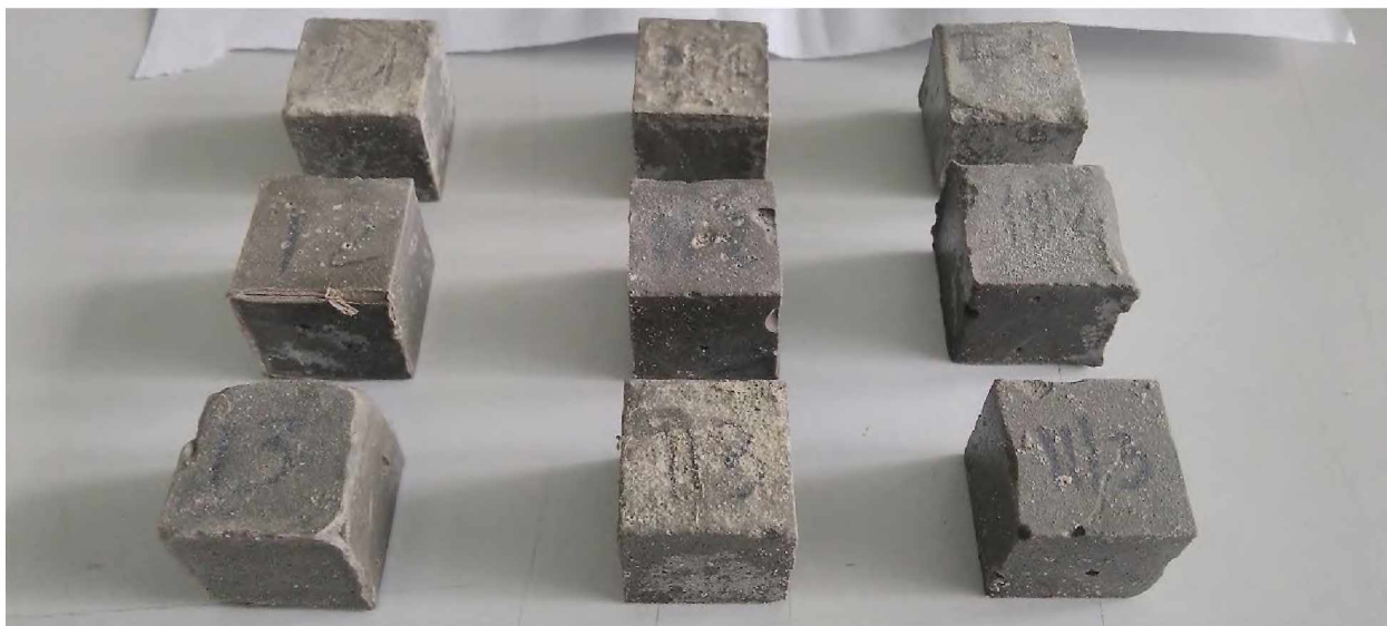
Рис 4.13. Порівняння вигляду зразків з добавками ефірів целюлози на 168 добу (після перебування у середовищі Na_2SO_4 ). З ліва на право: НВ, СВ, ВВ; з гори вниз - 0,25, 0,50, 0,75 мас. % відповідно.
