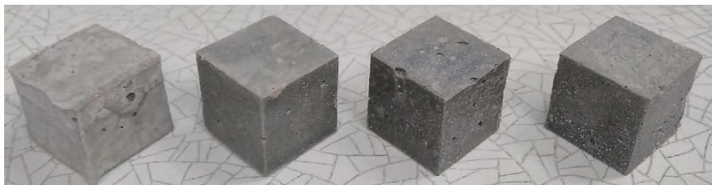
Рис. Б.8 Зразки з версататом (Neolith 4400) на 168 добу у середовищі MgSO_4 . Вміст добавки з ліва на право відповідно: 0 %; 1 %; 3 %; 5%.
