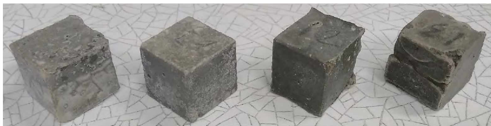
Рис. Б.4 Зразки з форміатом кальцію на 168 добу у середовищі Na_2SO_4 . Вміст добавки з ліва на право відповідно: 0 %; 1 %; 3 %; 5%.
