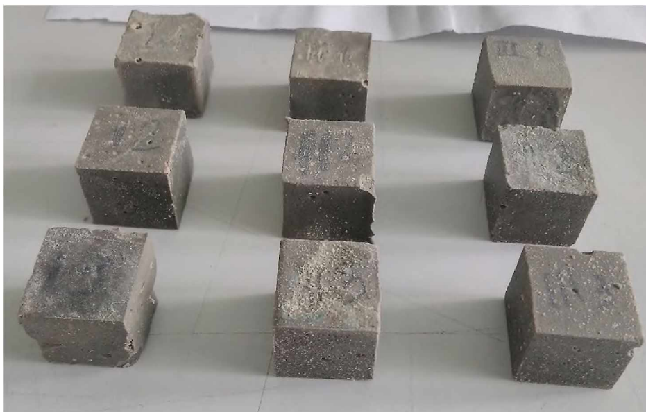
Рис 4.15. Порівняння вигляду зразків з добавками ефірів целюлози на 168 добу (після перебування у середовищі CaSO_4 ). З ліва на право: НВ, СВ, ВВ; з гори вниз - 0,25, 0,50, 0,75 мас. % відповідно.
