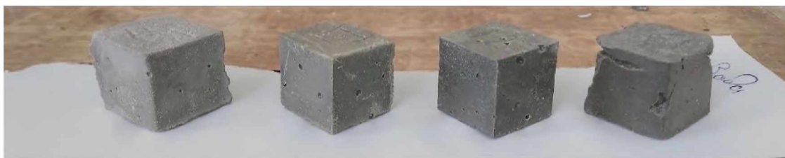
Рис 4.8. Стан зразків з метил гідроксиетил целюлозою на 168 добу (контрольні у воді). З ліва на право: Цемент, HB I, HB II, HB III
