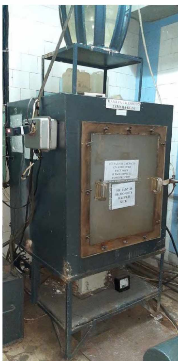
Рис. 2.2 Камера соляного туману типу КСТ-1
