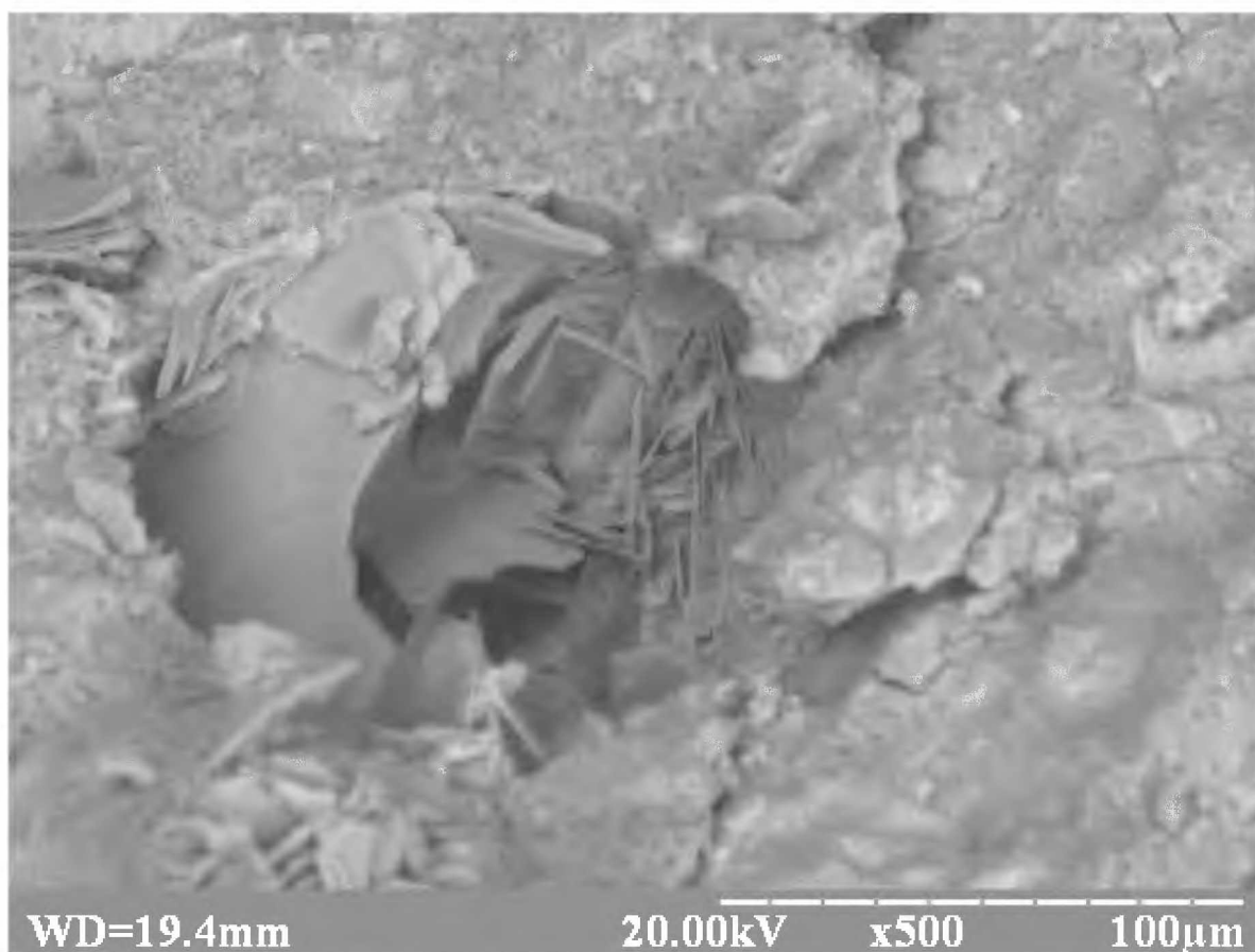
Рис. 4.32. Структура уражених зразків Neolith 4400 5 % у сульфатному середовищі через 168 днів
