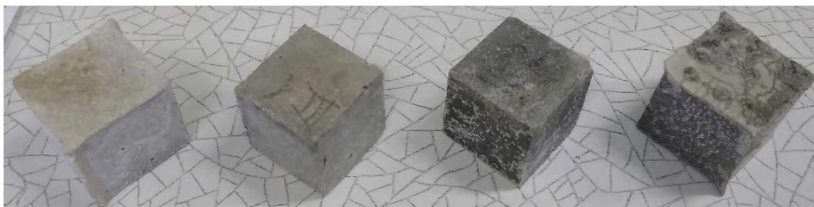
Рис Б.3 Зразки з вініл-акриловим сополімером (Neolith 6700) на 168 добу у воді. Вміст добавки з ліва на право відповідно: 0 %; 1 %; 3 %; 5%.
