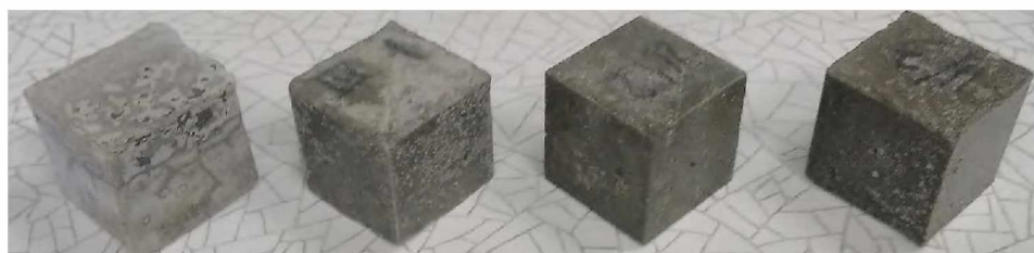
Рис. Б.6 Зразки з вініл-акриловим сополімером (Neolith 6700) на 168 добу у середовищі Na_2SO_4 . Вміст добавки з ліва на право відповідно: 0 %; 1 %; 3 %; 5%.
