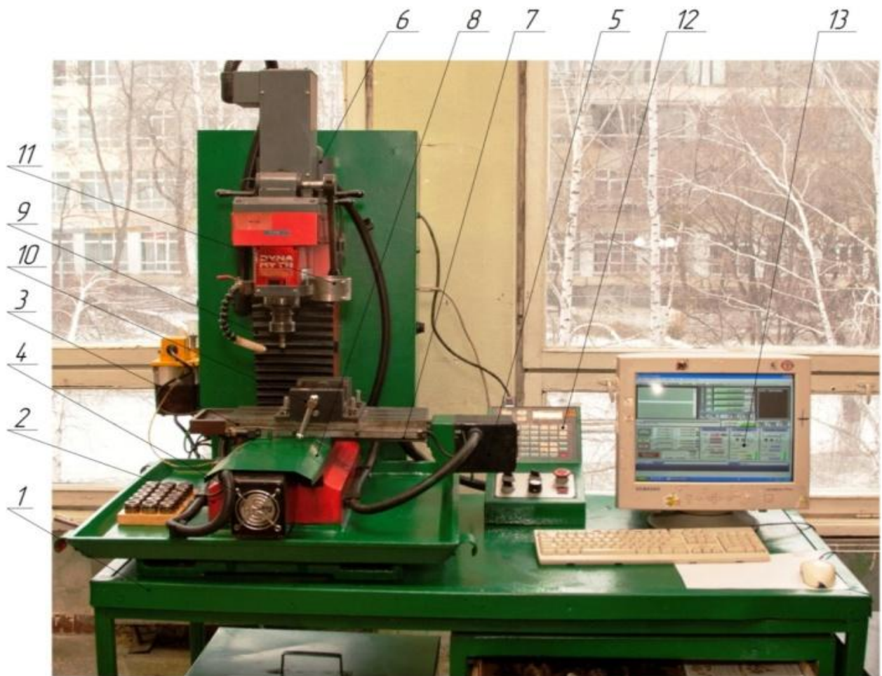
Рисунок 2.1.2. Фрезерний верстат Dynamyte 2800 з ЧПК для «фрезерної операції (030) (1 – стіл; 2 – станина; 3 – робочий стіл; 4,5,6 – крокові електродвигуни; 7,8,9 – полозки для повздовжнього, поперечного і вертикального переміщення; 10 – лещата; 11 – спеціальний пристрій; 12 – пульт керування; 13 – ЕОМ).
