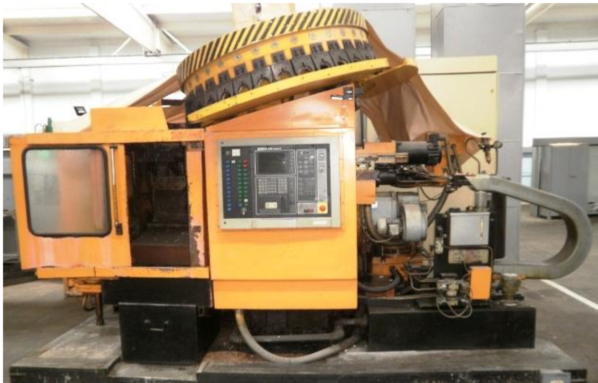
Рисунок 2.1.3. Багатоопераційний верстат IP320ПМФ з горизонтальною віссю обертання.
