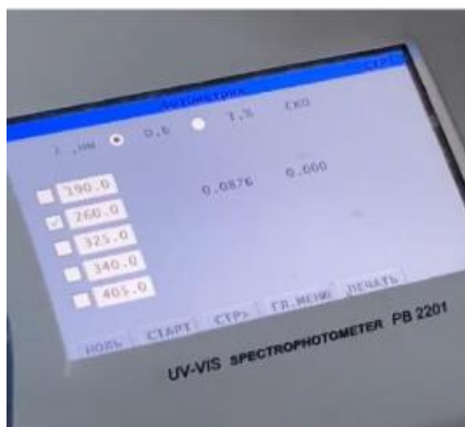
Рисунок 15 – Визначення оптичної густини зразку за довжини хвилі 260 нм.
