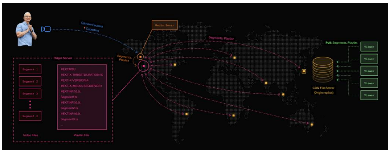
Рисунок 2.3 – Схема HLS: медіасервер розбиває потік на сегменти, формує плейліст і поширює дані через CDN. Клієнт завантажує плейліст і послідовно відтворює сегменти
