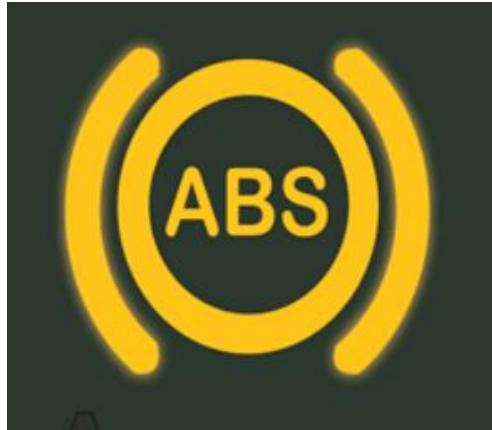
Рисунок 2.5 – Антиблокування гальм (ABS)
