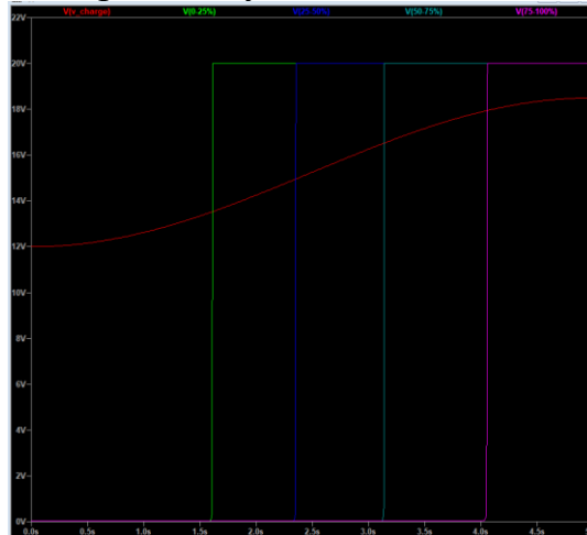
Рис 4.8– Ілюстрація увімкнення світлодіодів в симуляції.
