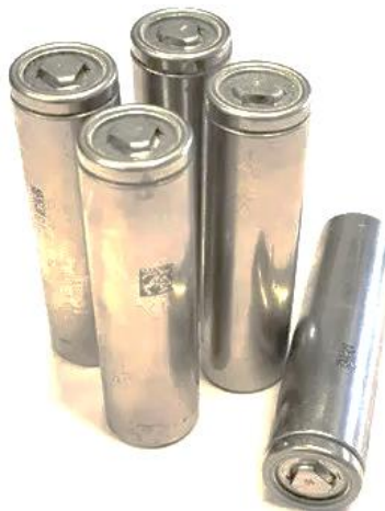
Рис 2.2 – NCA акумуляторні комірки 18650 фірми Panasonic, демонтовані з батарейного блоку електромобіля TESLA Model S
