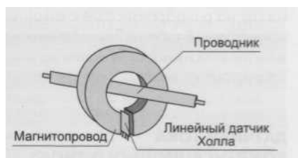
Рисунок 3.6 – структура датчика струму на ефекті Холла відкритого типу
