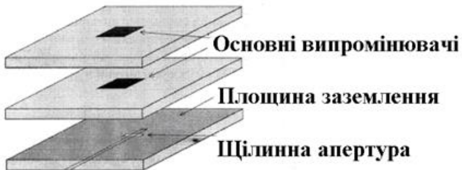
Рисунок 1.2.5 — Широкопasmовий дворезонаторний смужковий випромінювач із живленням за допомогою щілинної апертури
