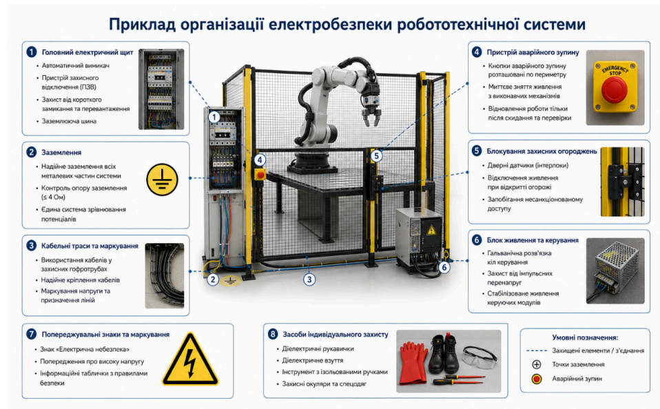
Рисунок 5.2 – Засоби електробезпеки робототехнічної системи
