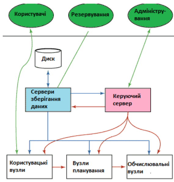
Рисунок 3.1 – Схема архітектури кластера
